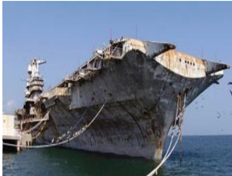
Figuras 18 e 19: porta-aviões ex-Oriskany no término de sua limpeza para tornar-se RAM.
