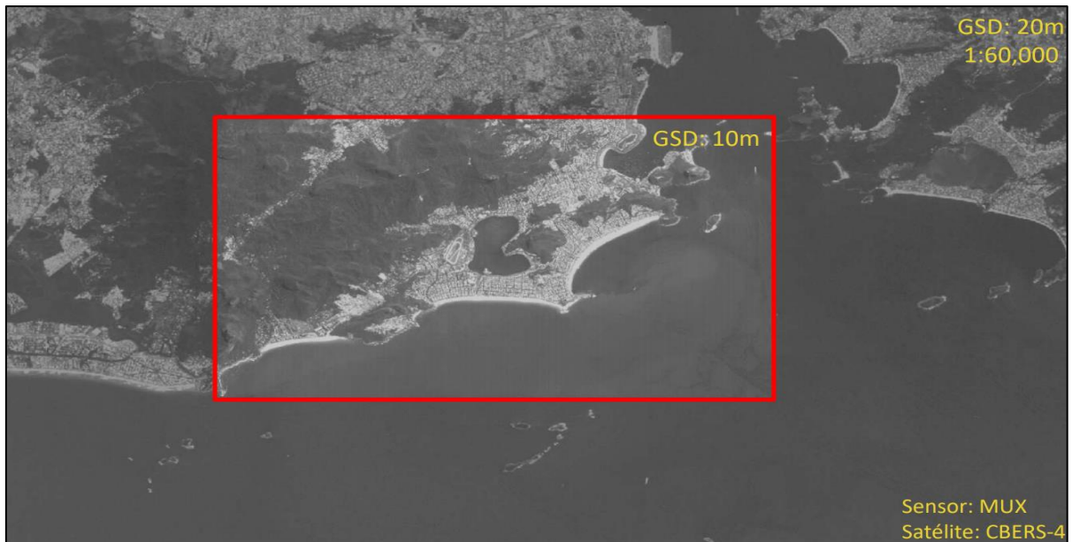
FIGURA 12 – Imagem produzida pelo satélite Terra, destacando a diferença entre uma imagem com resolução de 20 metros e uma resolução de 10 metros.
