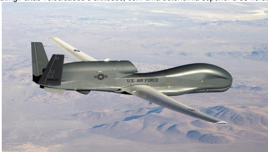
Figura 4: UAV Global Hawk - primeiro VANT com propulsão a jato, capaz de atingir altas velocidades e altitudes, com uma autonomia superior a 36 horas.
