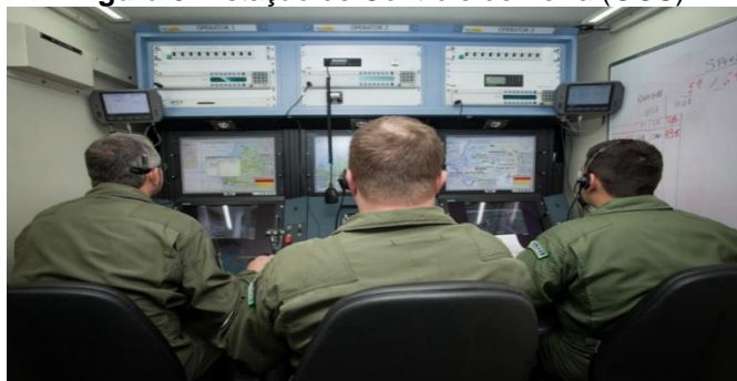
Figura 8: Estação de Controle de Terra (GCS)
