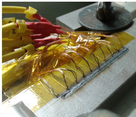
FIGURA 7.2 – Amostra com os termopares posicionados e aspecto superficial do cordão de solda.
