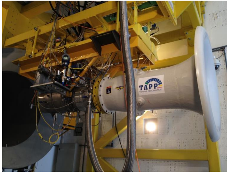
Figura 2. TAPP instalada em Banco de Ensaio no IAE
