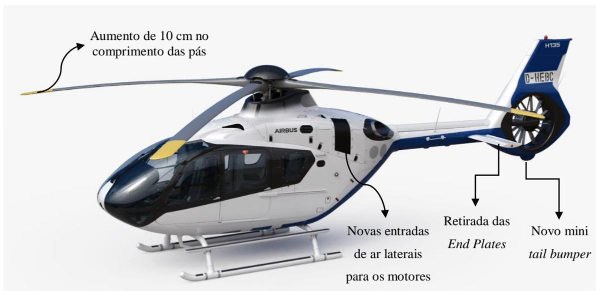
Figura 3.4 – H135 T3/P3 (Adaptado de: TURBOSQUID, 2020)<sup>2</sup>.
