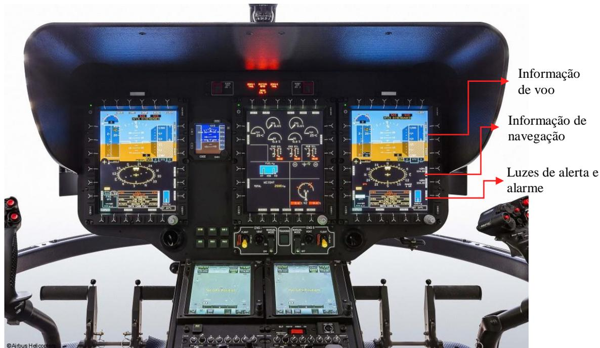
Figura 4.21 – Painel do H135 T3 com o sistema *Helionix*<sup>®</sup> composto por duas telas multifuncionais nas laterais e uma tela central com dados e sensores dos sistemas da aeronave (Fonte: AIRBUS HELICOPTERS, 2016).<sup>10</sup>
