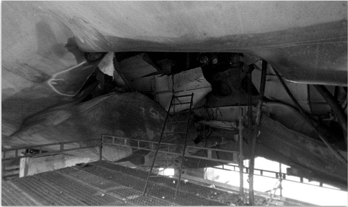
FIGURA 1 - Danos ao casco da Fragata USS Samuel B. Roberts (FFG-58), da Classe Oliver Hazard Perry, causados por uma mina durante o conflito Irã contra o Iraque (1988). Fonte: disponível em: < https://news.usni.org/wp-content/uploads/2015/05/Ffg58minedamage.jpg >
