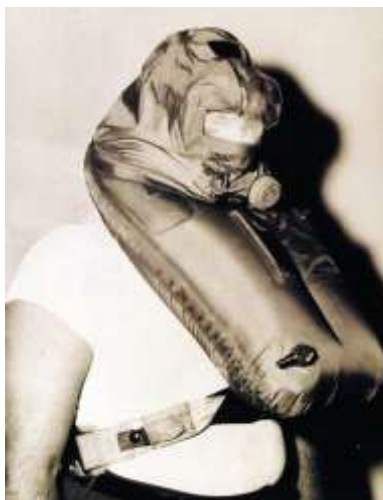
Figura 19 – Equipamento Steinke Hood utilizado no método de escape ou ascensão livre ( Free Ascent )
