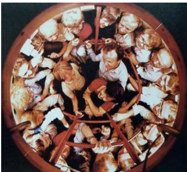
Figura 29 – Cápsula esférica alemã para escape (Esfera de GABLER)
