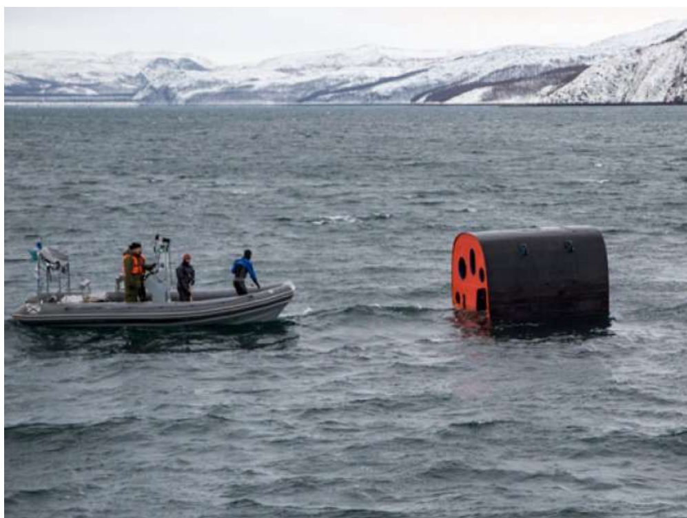
Figura 33 – Cápsula de escape russa sendo testada no mar
