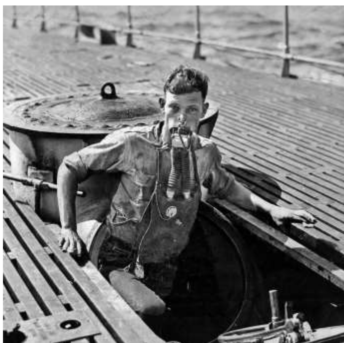
Figura 15 - Sistema de escape americano Momsen Lung
