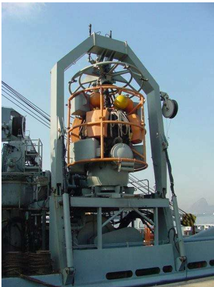
Figura 68 – Sino de mergulho saturado do NSS “Felinto Perry”
