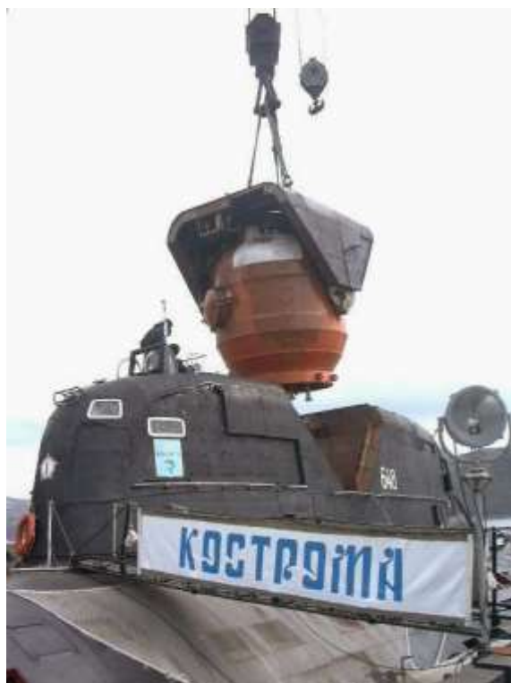
Figura 30 – Cápsula de escape utilizada no submarino russo Kostroma , Classe “Sierra I”
