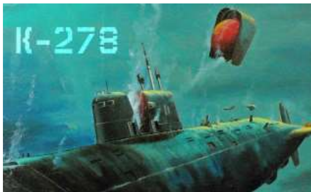
Figura 36 – Ilustração mostrando a ejeção da cápsula de escape do K-278 com cinco tripulantes a bordo
