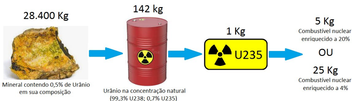
FIGURA 2 – Quantidade de material necessário para obtenção de 1Kg de U235, com base em mineral nuclear contendo 0,5% de urânio natural em sua composição.
