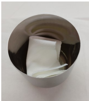
Figura 35 - Detalhe do esfregaço dobrado acomodado no interior do cadinho de platina
