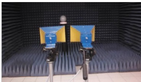
Figura 2: Medição da refletividade do refletor de Lüneburg.
