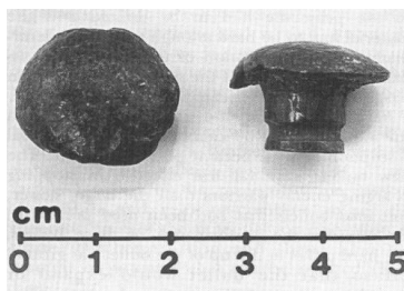
FIGURA 4 – projétil de fuzil Vetterli com sua característica deformação pós-impacto. Fonte: FACKLER, 1991, p. 157.
