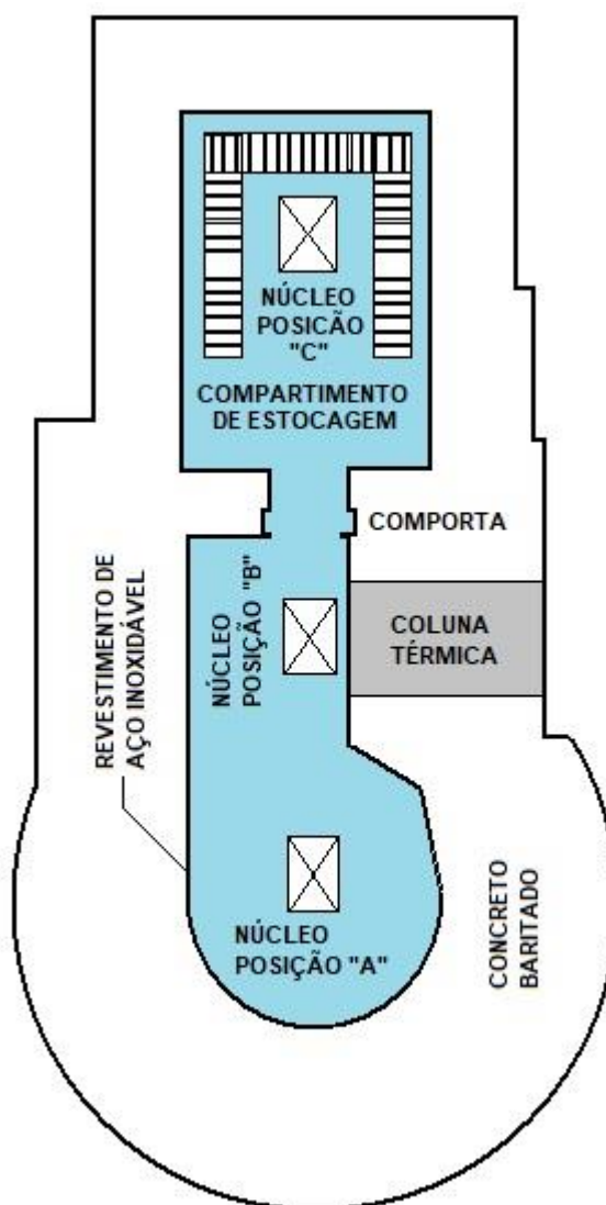
Figura 2 – Vista superior representativa da piscina do reator IEA-R1.
