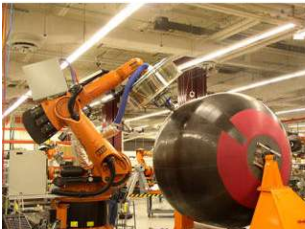
Figura 9 – Vaso de pressão esférico produzido por AFP.
