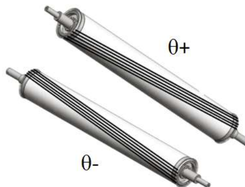
Figura 14 – Camadas helicoidais superpostas \pm\theta .
