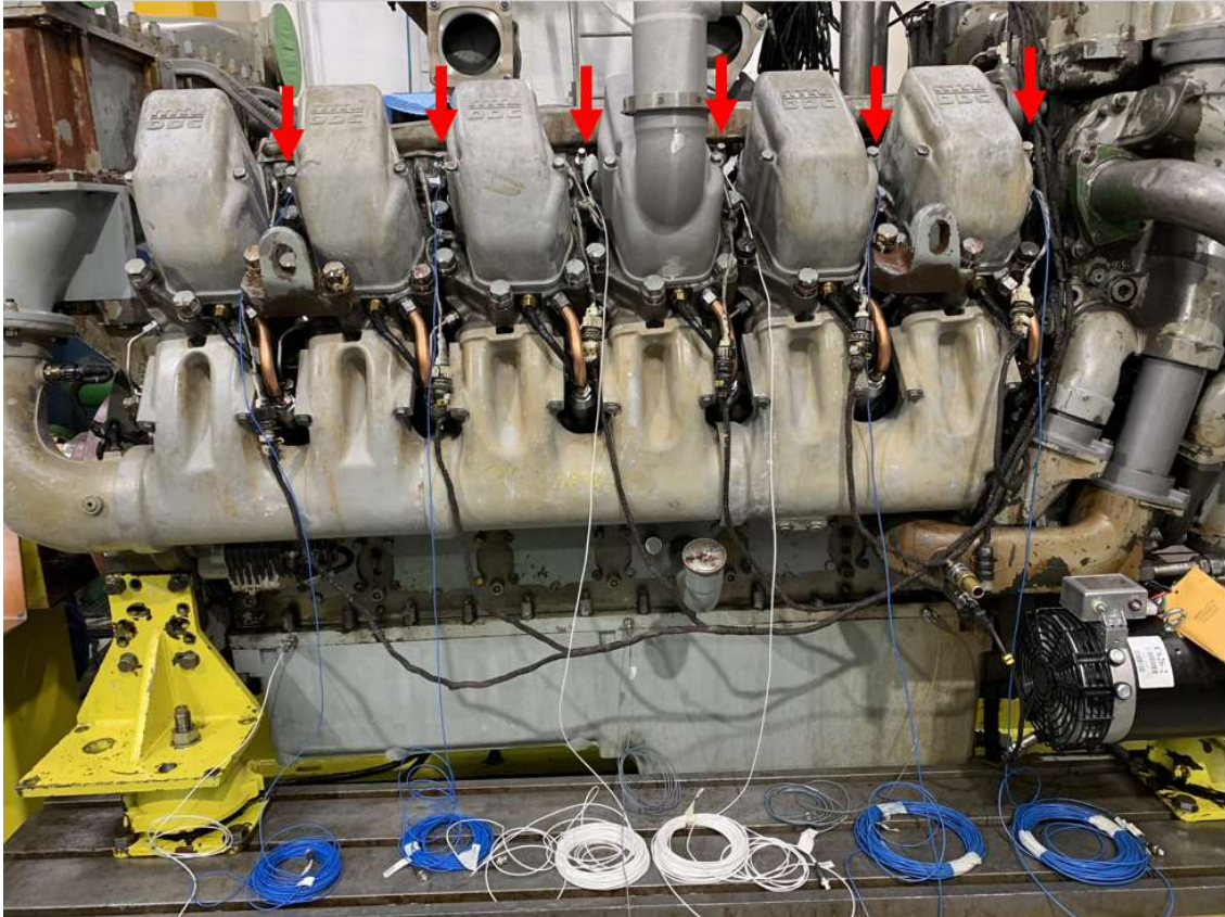
Figura 5.2 Indicação de instalação de seis acelerômetros em um dos bordos do bloco do Motor Diesel MTU/12V4000
