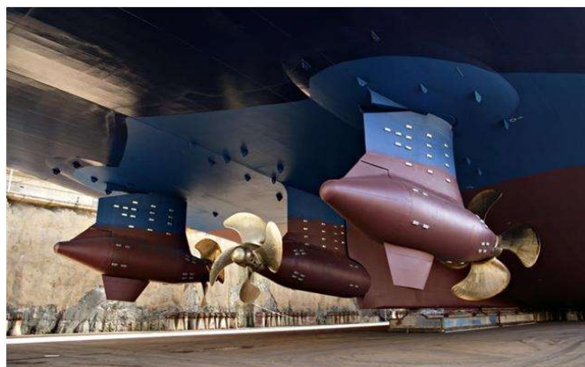
Figura 2: Propulsores Azimutais (Tecnologia Marítima, 2012).
