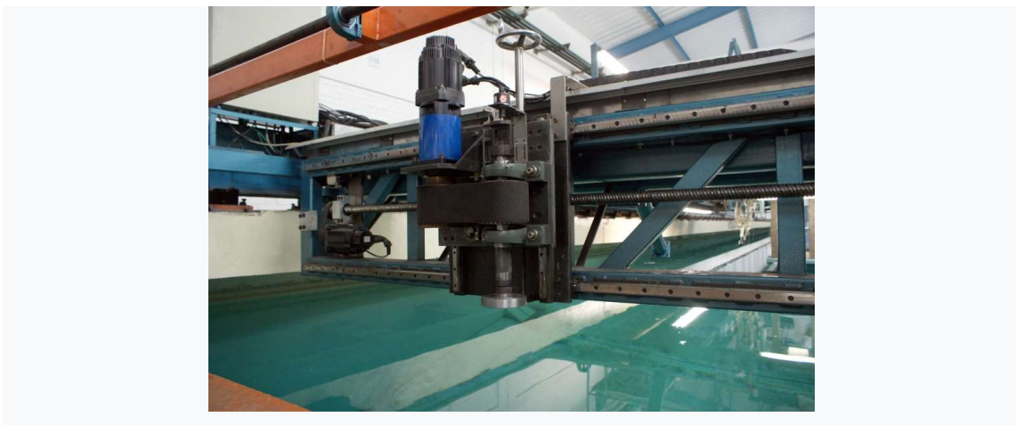
Figura 68: Dispositivo do PMM para movimentação em 2GL (IPT, 2022).
