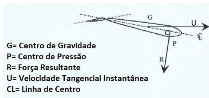
Figura 90: Posição do Centro de Pressão (adaptado de RUSSELL, 1993).
