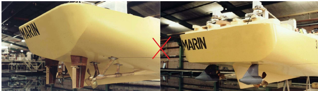
Figura 4: Sistema Convencional x Sistema Azimutal (TOXOPEUS et al., 2002).
