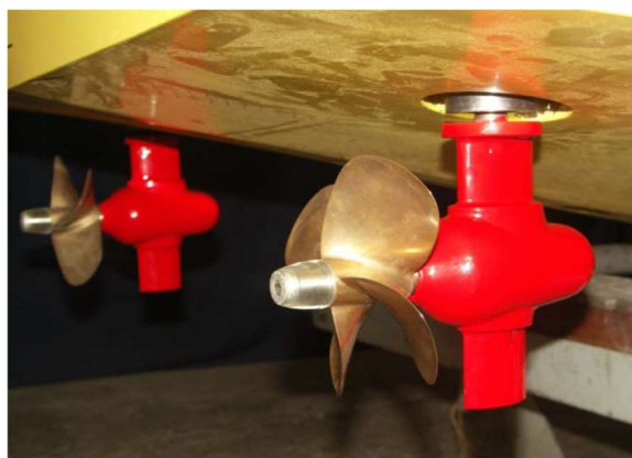
Figura 11: Sistema Propulsivo Azimutal (REICHEL, 2017).
