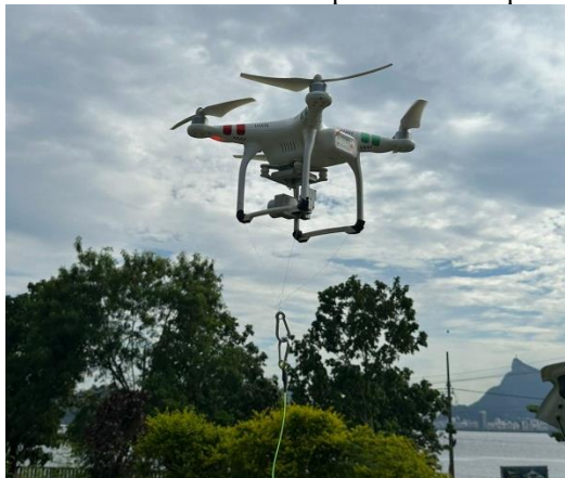
Figura 62: Drone Phantom 3 Standard com seu dispositivo de acoplamento do cabo de tração.
