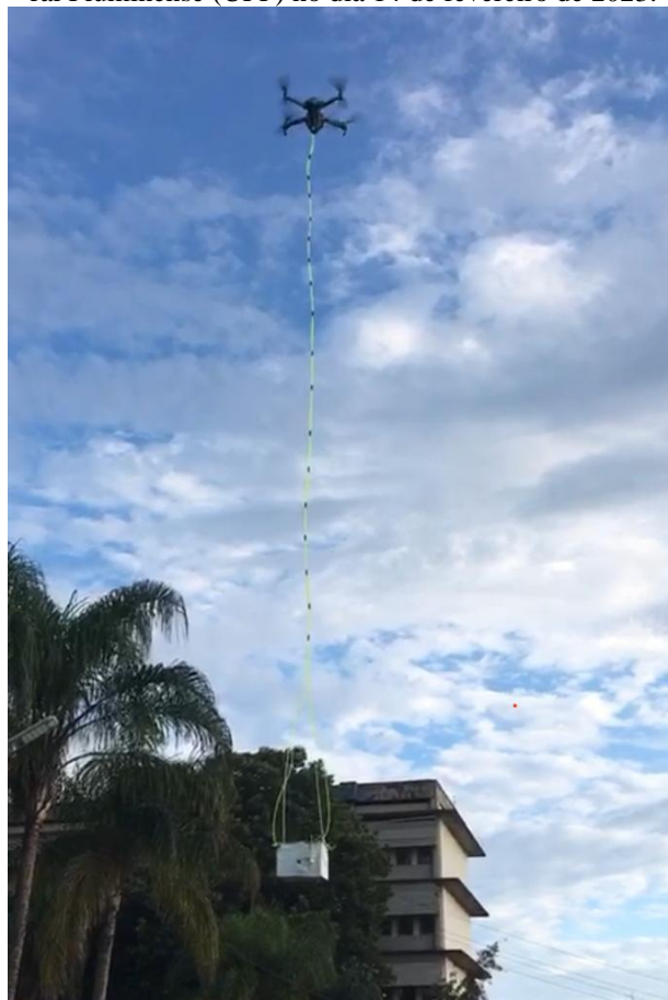
Figura 60: Perfilador atmosférico de baixo custo em operação no campus Praia Vermelha da Universidade Federal Fluminense (UFF) no dia 14 de fevereiro de 2023.
