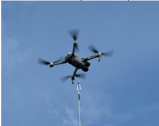
Figura 61: Drone Mavic Air 2 com seu dispositivo de acoplamento do cabo de tração.
