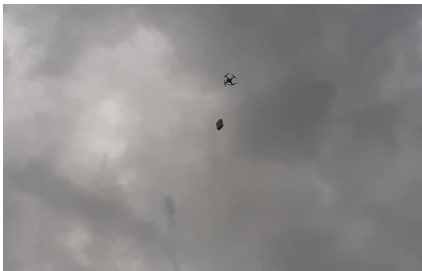
Figura 54: Perfilador atmosférico de baixo custo em operação com comportamento pendular no campus Praia Vermelha da Universidade Federal Fluminense (UFF) no dia 22 de agosto de 2022.
