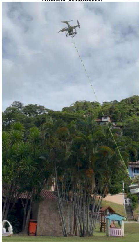
Figura 68: Drone Phantom 3 Standard em teste de carga do anemômetro ultrassônico PRSens apresentando movimento oscilatório.
