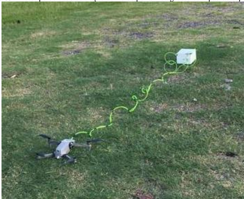
Figura 59: Protótipo de cabo de tração de fio de poliamida grosso com padrão espiralado.
