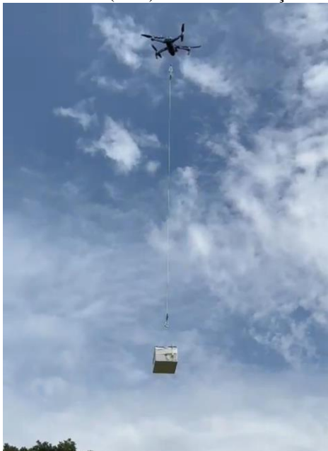
Figura 64: Teste de estabilidade em voo com drone Mavic Air 2 no campus Praia Vermelha da Universidade Federal Fluminense (UFF) no dia 6 de março de 2023.
