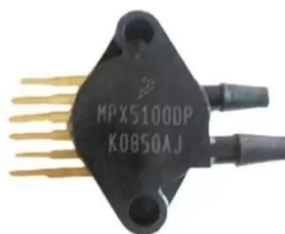
Figura 26: Sensor MPX5100DP, utilizado para a medição de pressão diferencial e cálculo da velocidade do vento em função da pressão medida.
