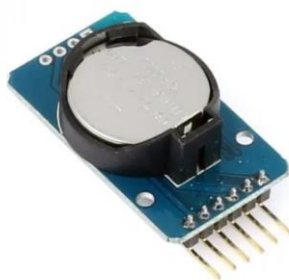
Figura 30: Relógio programável RTC DS3231 utilizado para sincronia de medições e registro do tempo em horas, minutos e segundos.
