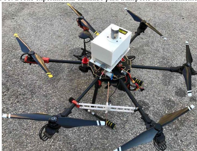
Figura 18: Drone experimental utilizado para transporte de instrumento sensor.
