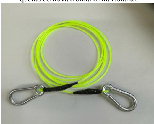
Figura 63: Cabo de tração do perfilador atmosférico de baixo custo elaborado com fio de poliamida grosso, mosquetão de trava e olhal e fita isolante.
