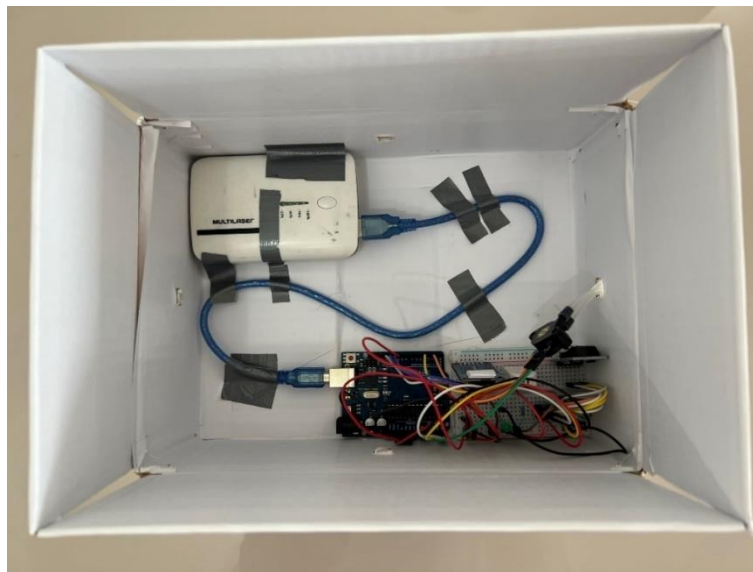
Figura 38: Vista superior da caixa maior do perfilador atmosférico de baixo custo aberta.
