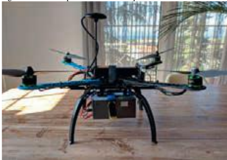
Figura 19: Drone experimental com componentes Arduino embarcados.
