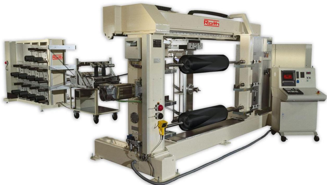
Figura 14 – Exemplar de uma máquina para processo de filament winding
