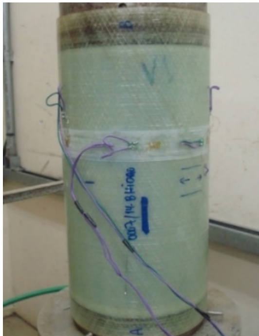
Figura 31 – Cilindro de FV/epóxi: a) no início do teste; b) após a ruptura com a conclusão do teste de fluência
