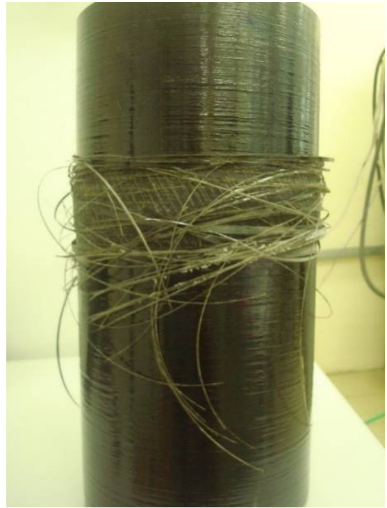
Figura 30 – Cilindro de FB/epóxi: a) no início do teste; b) após ruptura com a conclusão do teste de fluência
