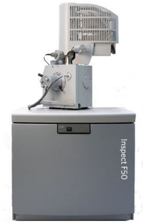
Figura 20 – Equipamento de MEV FEI Inspect S50 utilizado no presente trabalho para análise de ruptura das fibras
