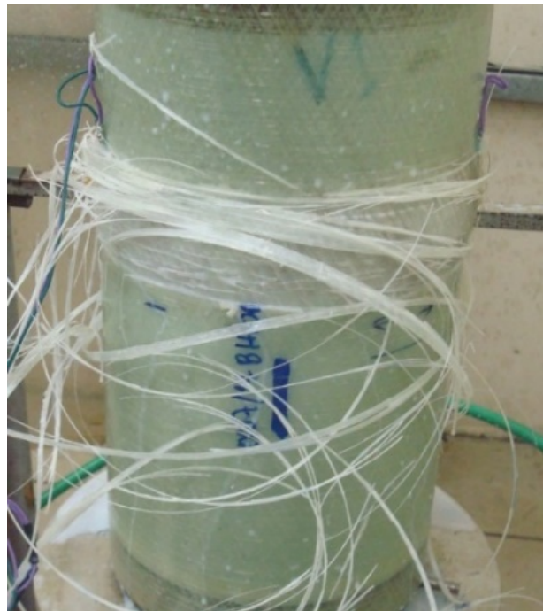
Figura 31 – Cilindro de FV/epóxi: a) no início do teste; b) após a ruptura com a conclusão do teste de fluência
