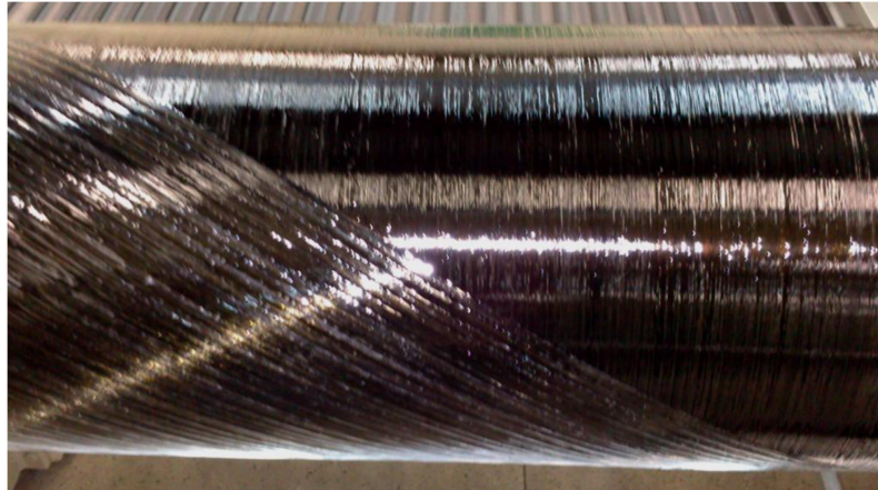
Figura 17 – Bobinamento helicoidal intermediário a -30^\circ com reforço de FB
