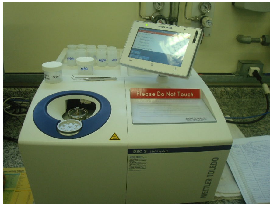
Figura 19 – Calorímetro Mettler-Toledo DSC-3 utilizado neste estudo para realização de DSC
