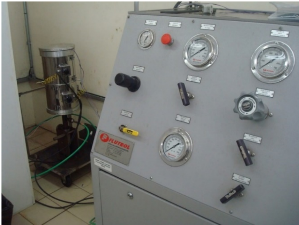
Figura 23 – Unidade de controle da máquina de pressão hidrostática com forno de aquecimento do cilindro
