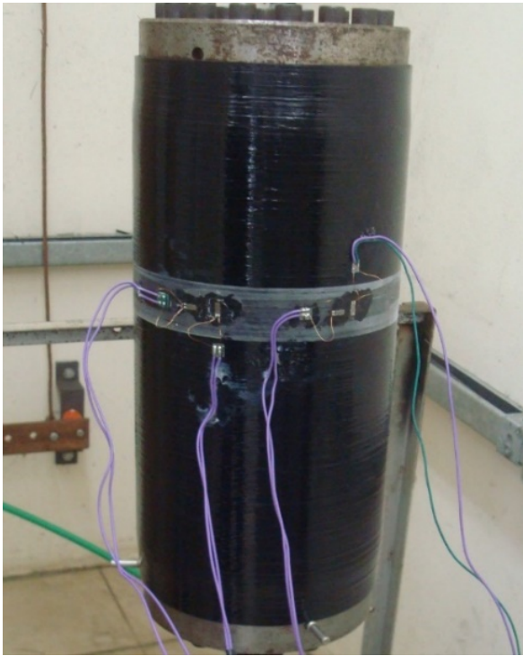
Figura 30 – Cilindro de FB/epóxi: a) no início do teste; b) após ruptura com a conclusão do teste de fluência
