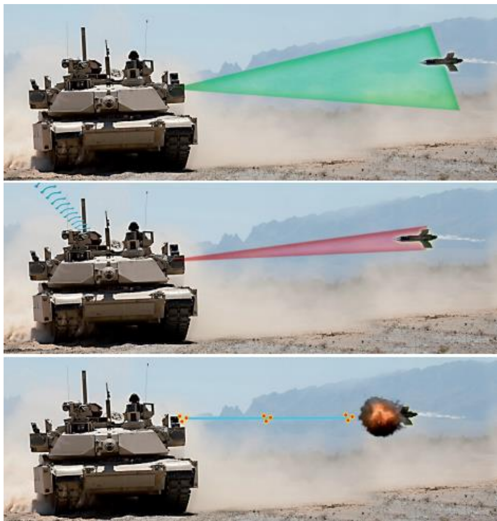
Figura 14 – Funcionamento do sistema de defesa Trophy . Fonte: Rafael Advanced Defense Systems Ltd.
