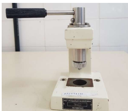
Figura 3.4: Mini prensa adaptada para corte dos corpos de prova usados no TMA
