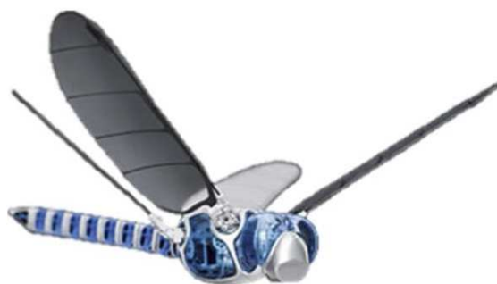
Figura 2.15: Robô voador dotado de atuadores de SMA, JANI et al. (2014).
