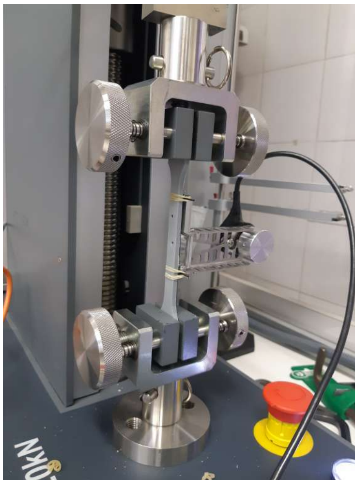
Figura 3.14 – CP 01 montado na máquina para ensaio
