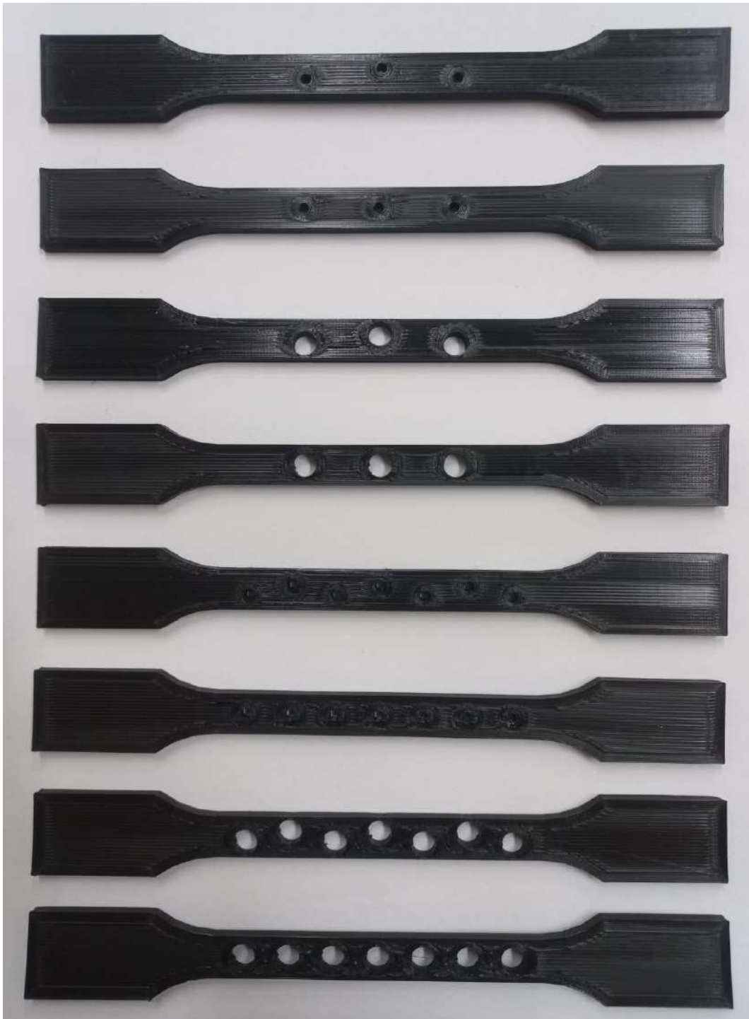
Figura 3.9 – CPs impressos com defeitos circulares
