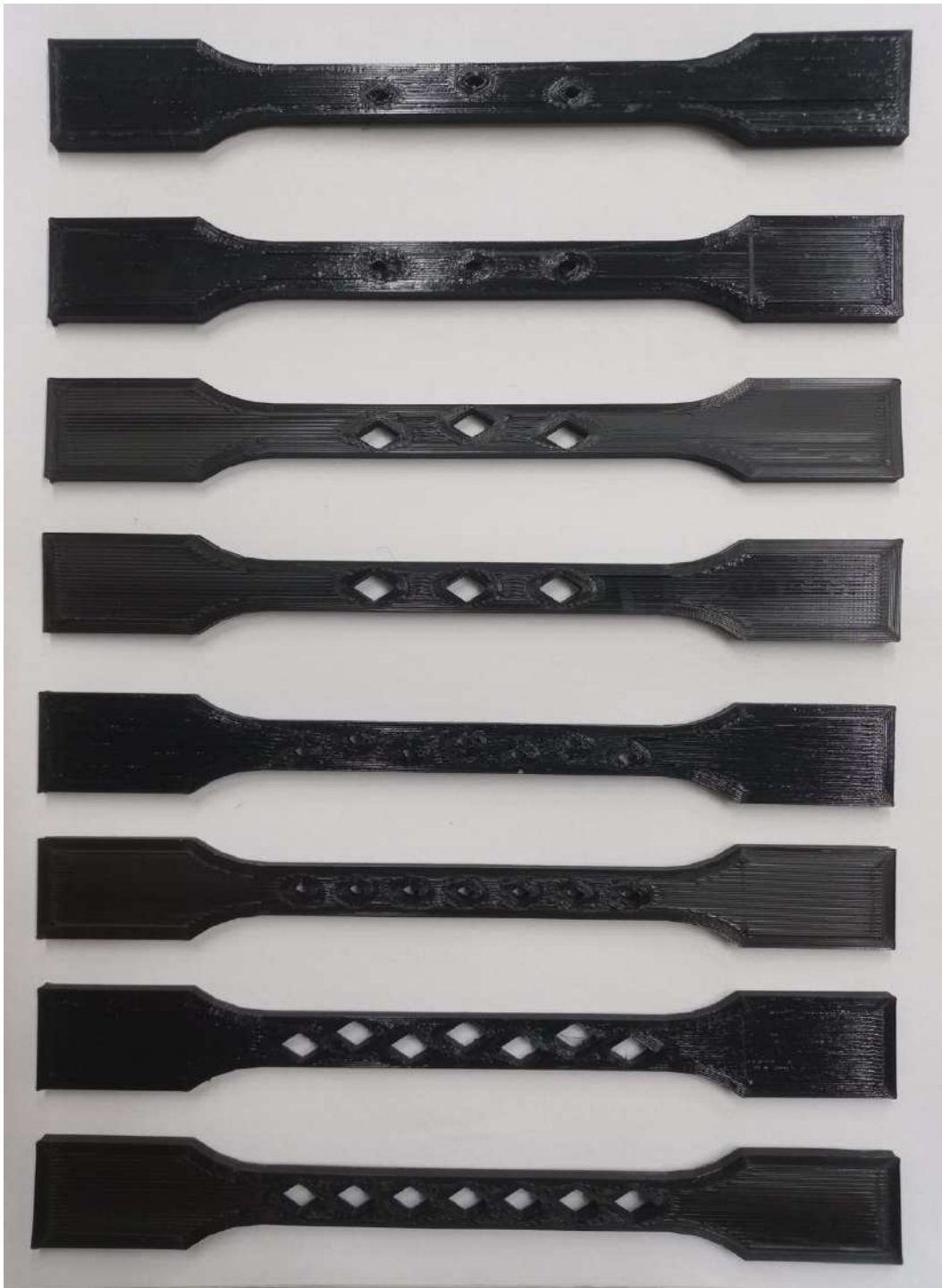
Figura 3.10 – CPs impressos com defeitos losangulares
