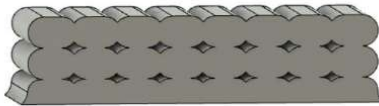
Figura 2.7 – Presença dos air gaps na estrutura impressa (CAVALCANTE, 2022)
