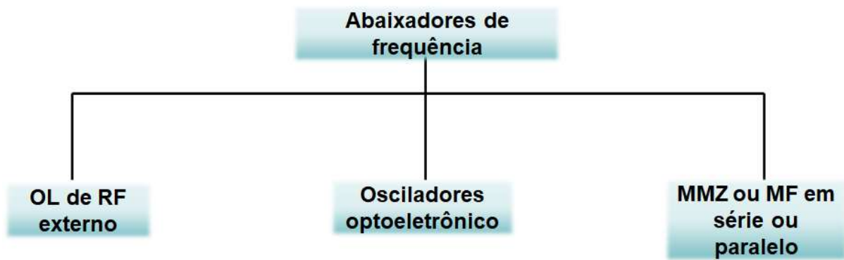
Figura 2.6 – Diagrama esquemático que apresenta as principais abordagens de abaixadores de frequência baseados em MOF em três grupos quanto a forma de implementação do abaixamento em frequência do sinal.
