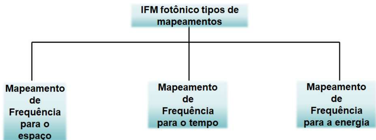
Figura 2.5 – Diagrama esquemático que apresenta as principais abordagens de IFM baseados em MOF em três grupos quanto a forma de mapeamento de frequência.
