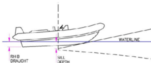
Figura 9 – Ilustração representando profundidade da soleira de uma rampa de popa e sua extensão abaixo da linha d' água durante a recuperação de uma embarcação orgânica.
