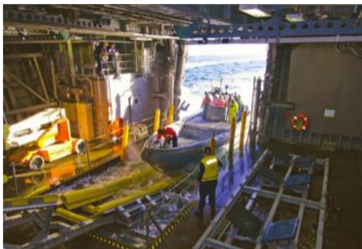
Figura 5 – Alagamento na região da rampa de popa por ocasião de abertura da porta de acesso ao mar.
