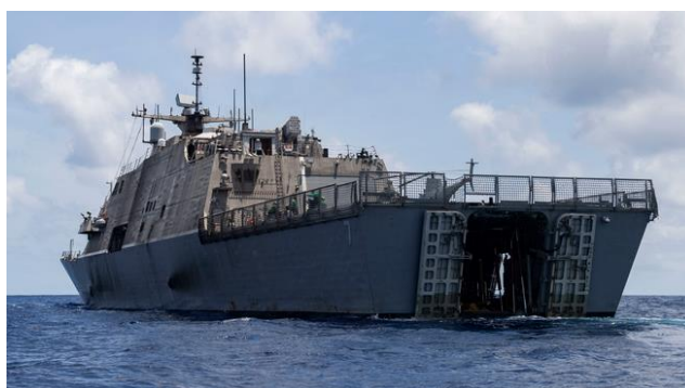
Figura 8 – Modelo de configuração de porta de acesso ao mar articulada para as laterais empregado por LCS Freedom da marinha norte americana.
