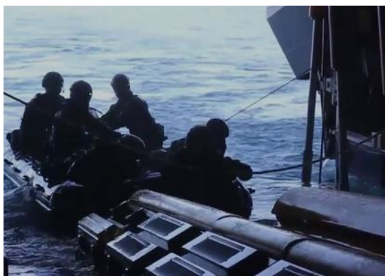
Figura 10 – Modelo de trilhos longitudinais tubulares empregados para o acesso de veículos orgânicos à rampa de popa a bordo de navio escolta do tipo LCS Freedom da marinha norte americana.
