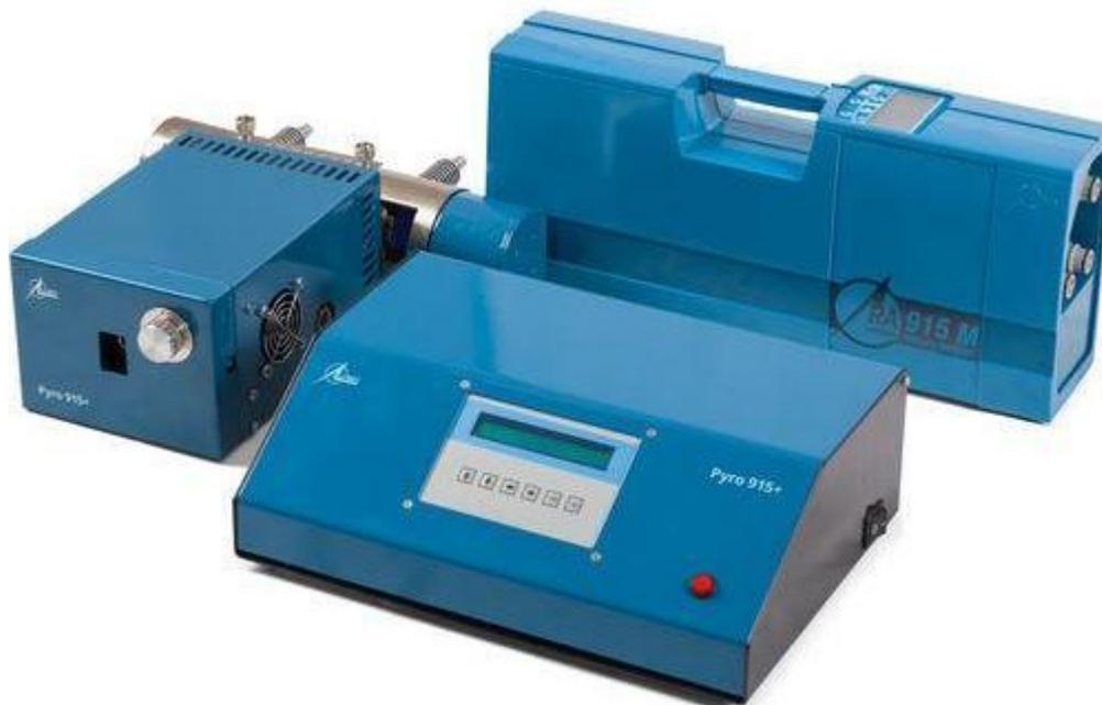
Figura 13. Equipamento LUMEX utilizado para as análises de mercúrio total.
