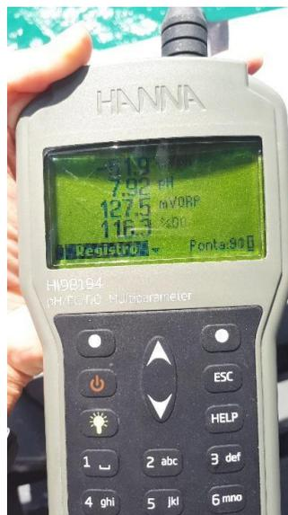
Figura 10. Sonda multiparâmetro utilizada em campo.
