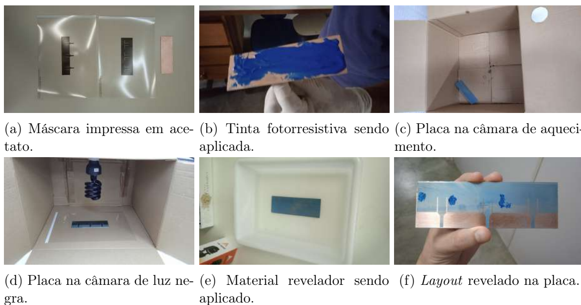
Figura 4.34: Etapas do processo realizado com o método artesanal de fototransferência. Fonte: Elaborado pelo autor.
