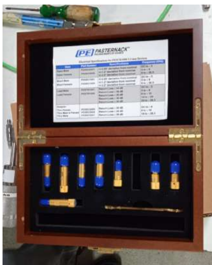
Figura 4.39: Kit de calibração Pasternack. Fonte: Elaborado pelo autor.
