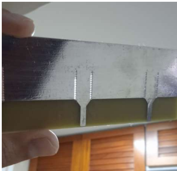
Figura 4.38: Metalização dos elementos PBG do protótipo fabricado com o método HASL. Fonte: Elaborado pelo autor.
