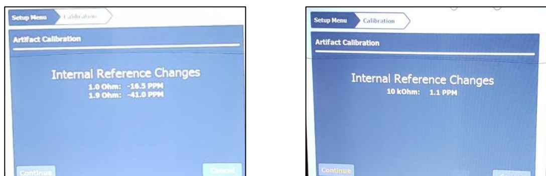
Figura 6 – Informação fornecida pelo 5730A dos ajustes internos nos parâmetros de resistência.
