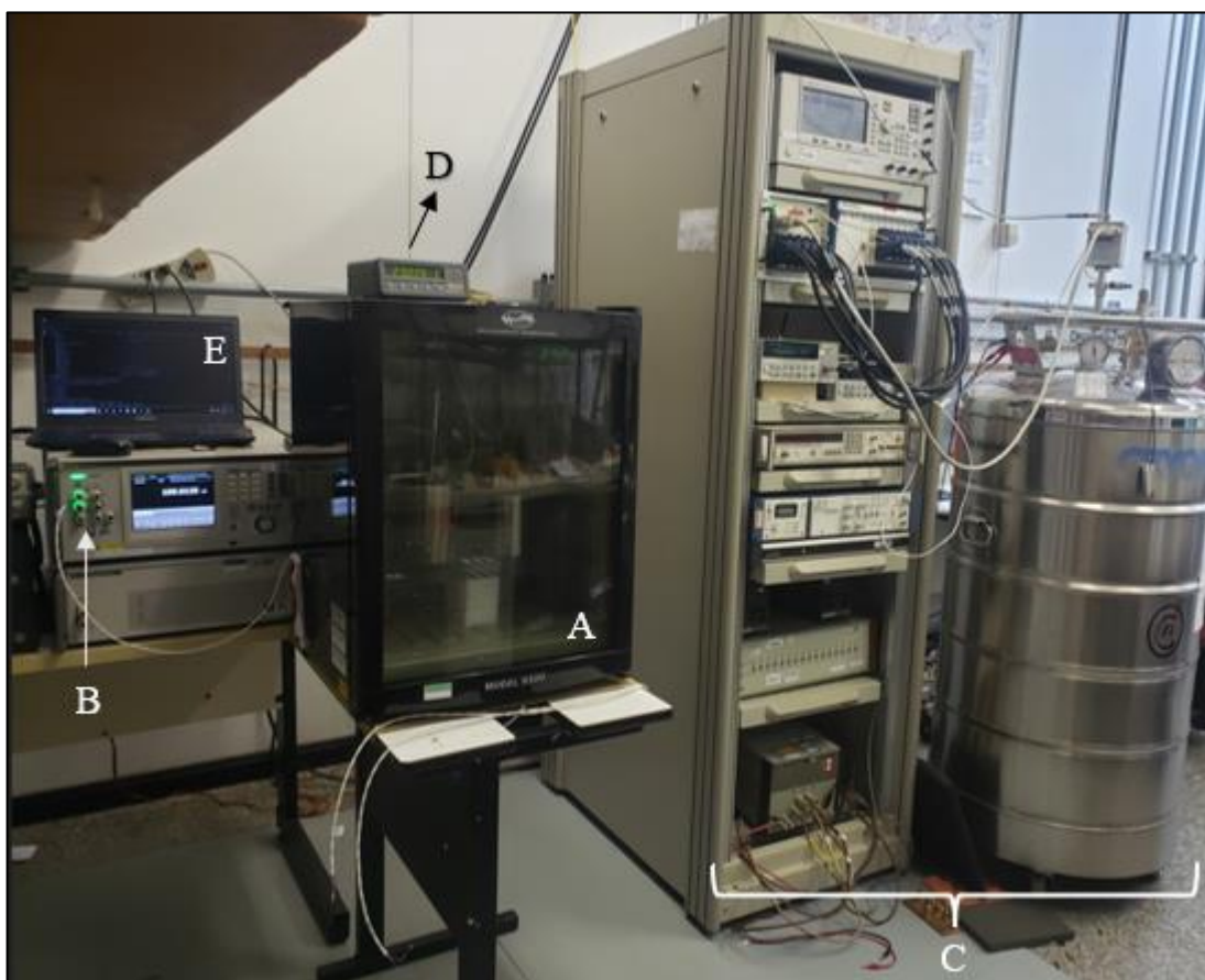
Figura 31 – Disposição dos equipamentos utilizados nas medições com resistores PT16, PT17 e PT20.
