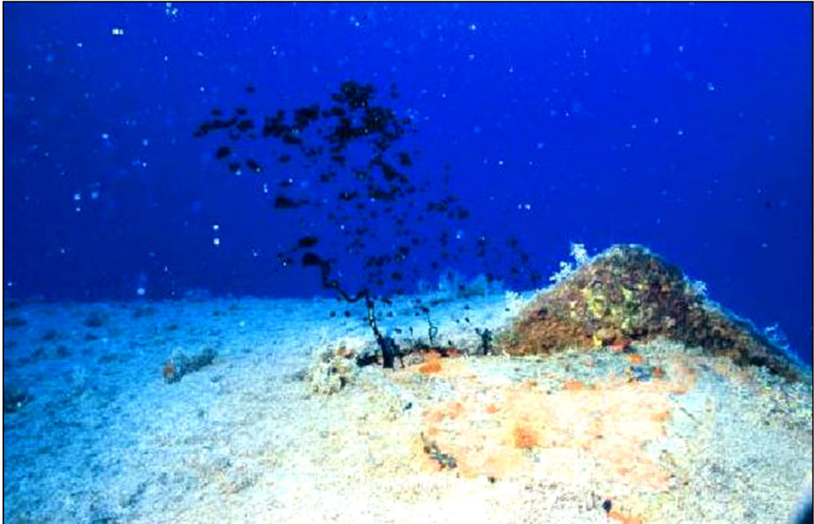
Figura 9– Vazamento de óleo no casco do navio tanque ex-USS Mississinewa Fonte: U.S. Navy Supervisor of Salvage (disponível em MICHEL et al. , 2005)
