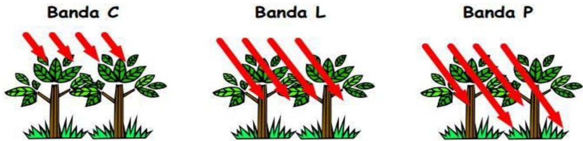
Figura 4 - Comportamento das ondas eletromagnéticas de acordo com a frequência de operação.
