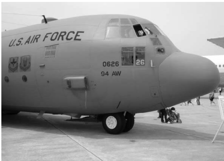
Figura 2.1 – Antena de radar encapsulada em radome na parte frontal de uma aeronave americana.
