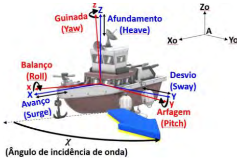
Fig. 1. Definição dos movimentos do navio e do ângulo de incidência de ondas [8].
