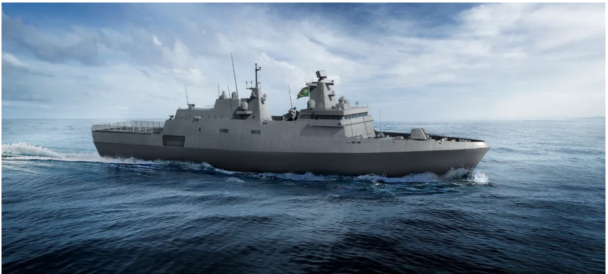
Figura 12- Ilustração do Projeto FCT com o radar TRS-4D no seu mastro principal
