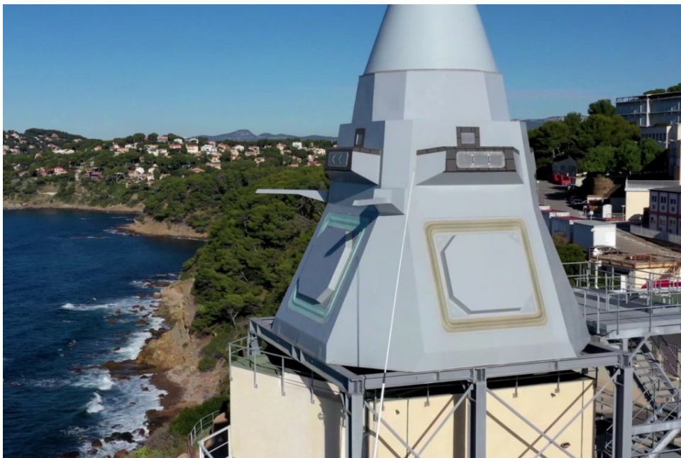
Figura 11- Antenas do radar Sea Fire em fase de testes pré integração
