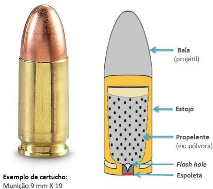
Figura 2.1 – Exemplo de cartucho de munição 9 mm.
