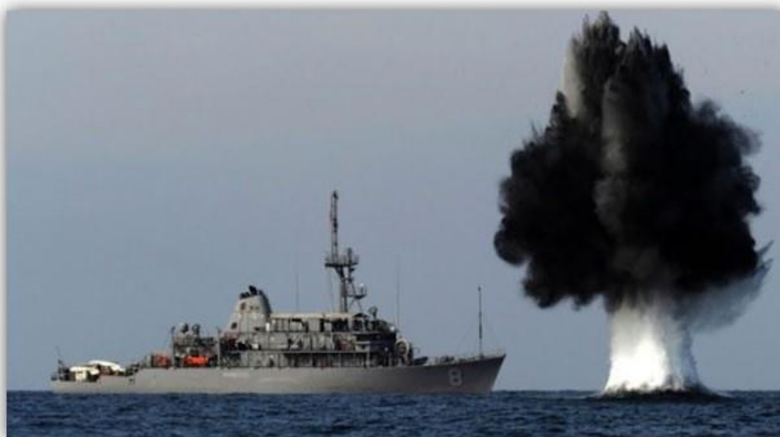
Figura 7 – Mina explodindo a partir de uma varredura de influência.
