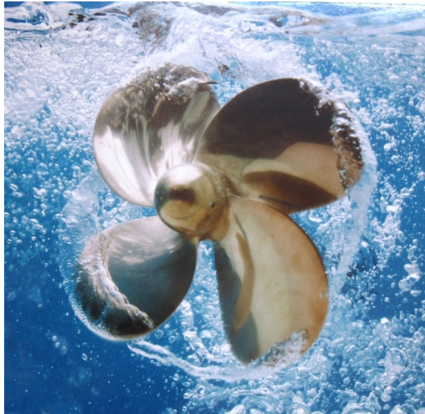
Figura 12 – Fenômeno de Cavitação no Hélice, fonte: Instituto de Pesquisas Tecnológicas
