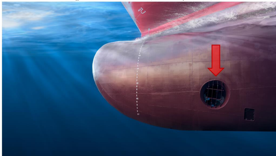
Figura 3 - Bow thruster (indicado pela seta)
