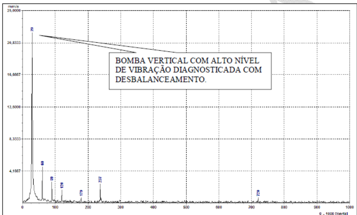
Figura 5: Bomba vertical diagnosticada com desbalanceamento.
