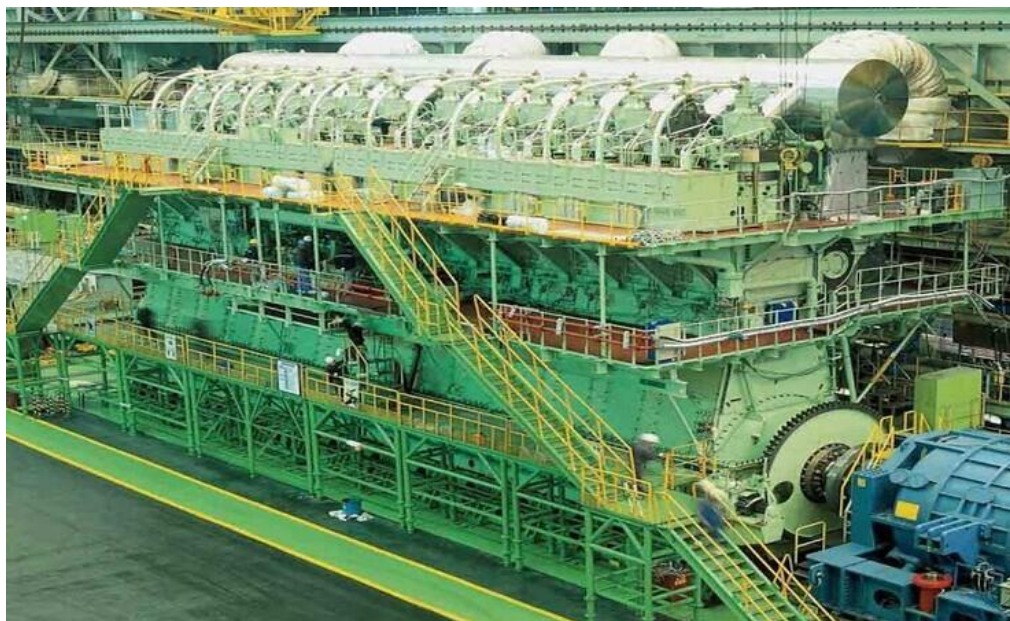
Figura 5 - Motor de navio RT-flex96C, projetado para grandes navios
