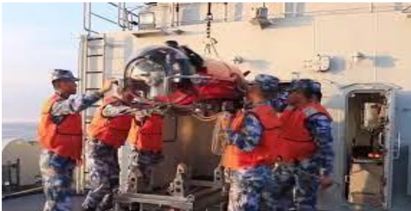
Figura 1- O MHS Donggang da Classe Wozang realizando o lançamento de um veículo de neutralização de minas.
