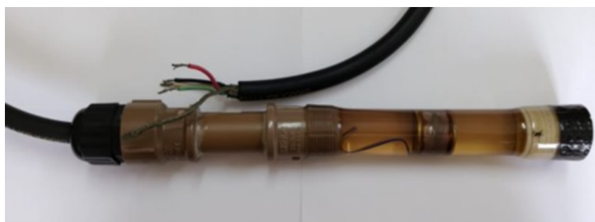
Figura 4.5: Hidrofone desenvolvido no IEAPM com material de baixo custo.
