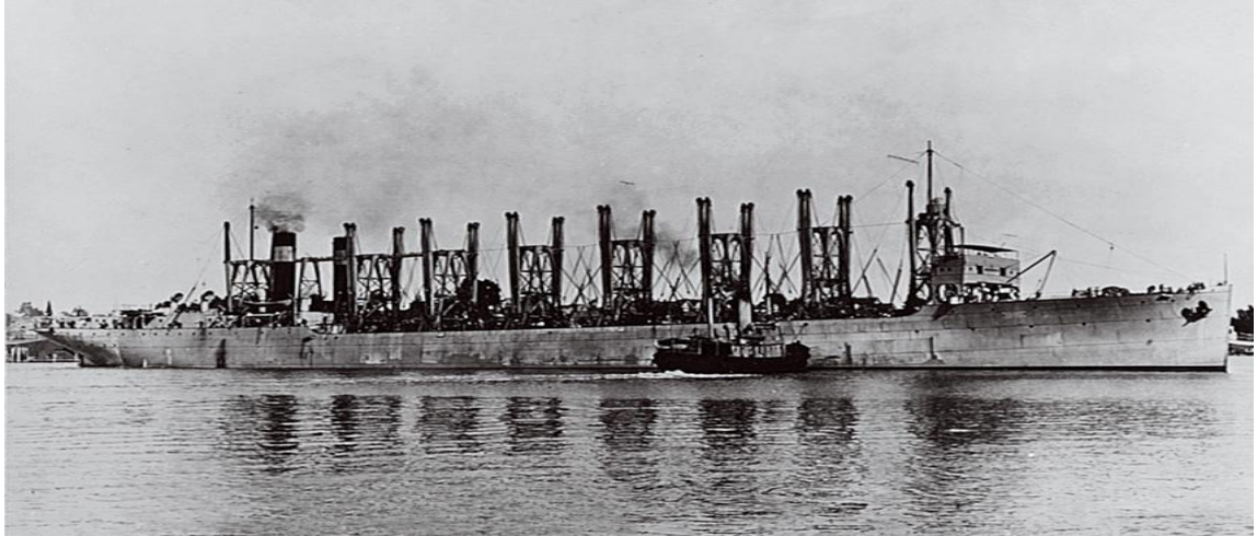
Figura 3: USS “Jupiter”, primeiro navio militar dotado de propulsão elétrica (Arrington,1998).
