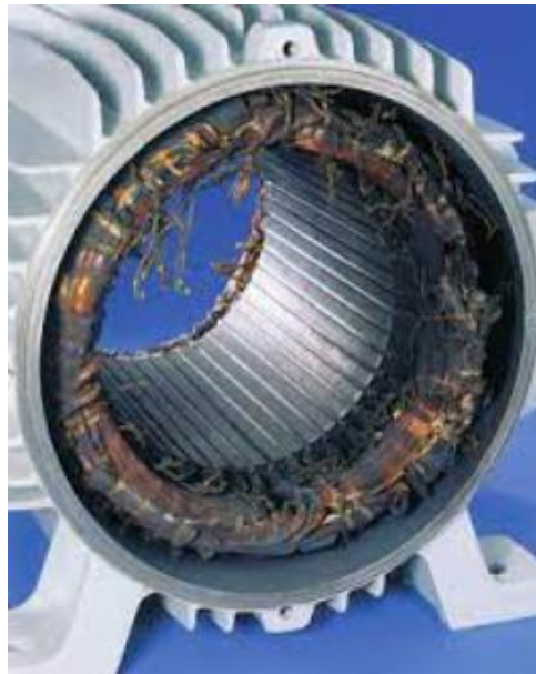
Figura 18 – Enrolamento do estator com deterioração do isolamento em uma fase
