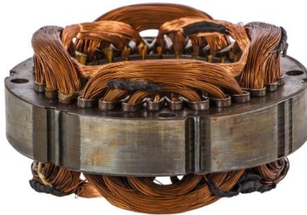
Figura 17 – Enrolamento do estator em boas condições de funcionamento
