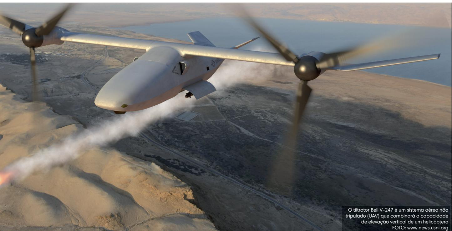
O tiltrator Bell V-247 é um sistema aéreo não tripulado (UAV) que combinará a capacidade de elevação vertical de um helicóptero
