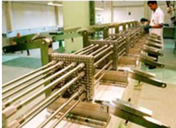
Figura 4 - Dispositivo para inserção das varetas de combustível no EC.
