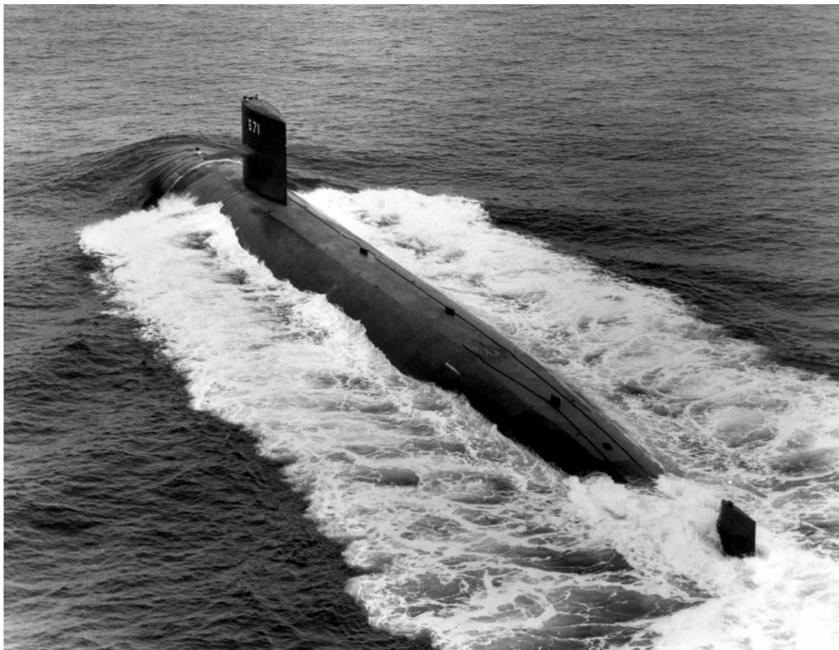
Figura 1 – USS Narwhal (USS-671), primeiro reator nuclear operando em circulação natural.
