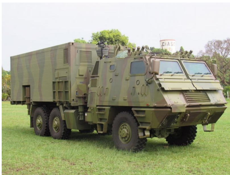
Figura 10 - Viatura Oficina Veicular e Eletrônica (OFVE) (Fonte: CGCFN 50.4 – MANUAL DE EMPREGO DE ARTILHARIA DE FOGUETES)
