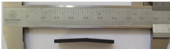
Figura 32 - CP flexão (16:1) - Fibra A – 3 pontos
