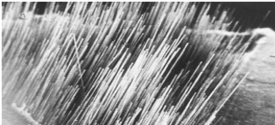
Figura 19 - Ilustração de falha escova ( brush-like failure )
