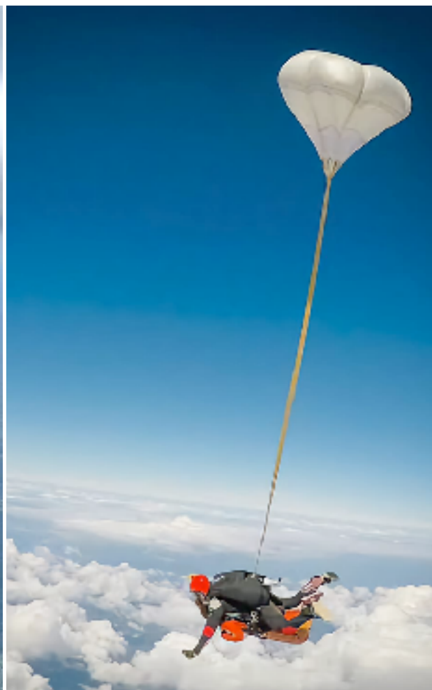
Figura 12 - Exemplo de Drogue Parachute.
