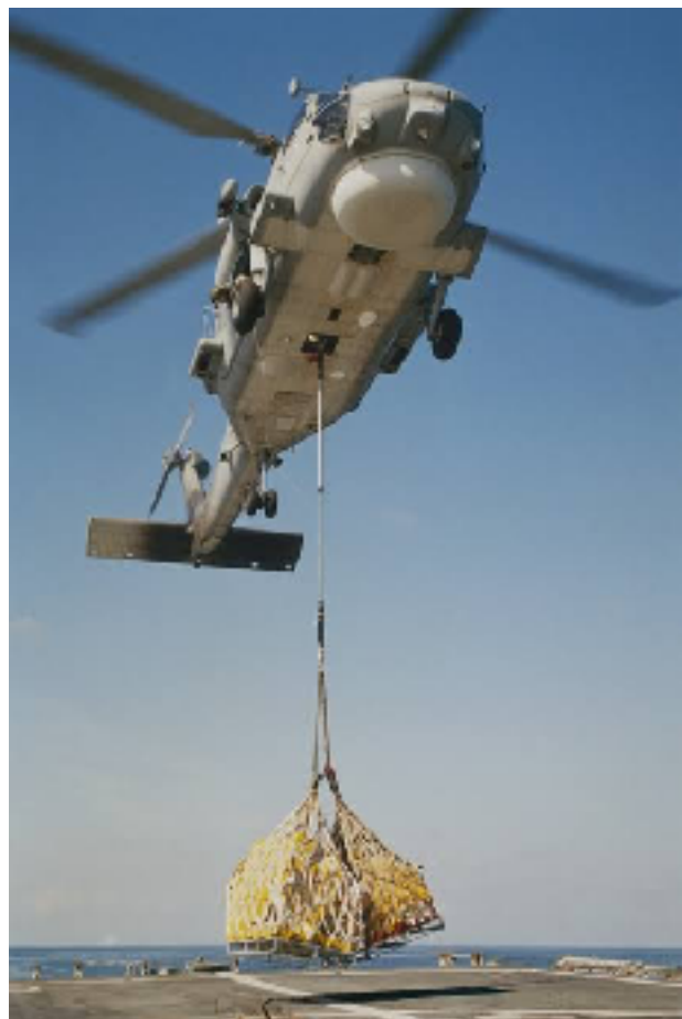
Figura 10 - Transporte com Rede de Transporte de Carga.
