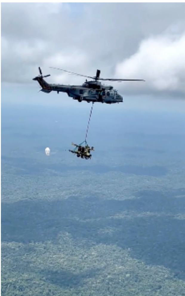
Figura 11 - Canhão sendo transportado com o paraquedas de estabilização.
