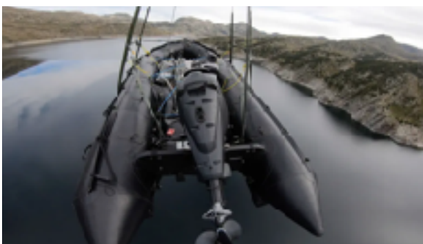
Figura 8 - Transporte com Estropo.
