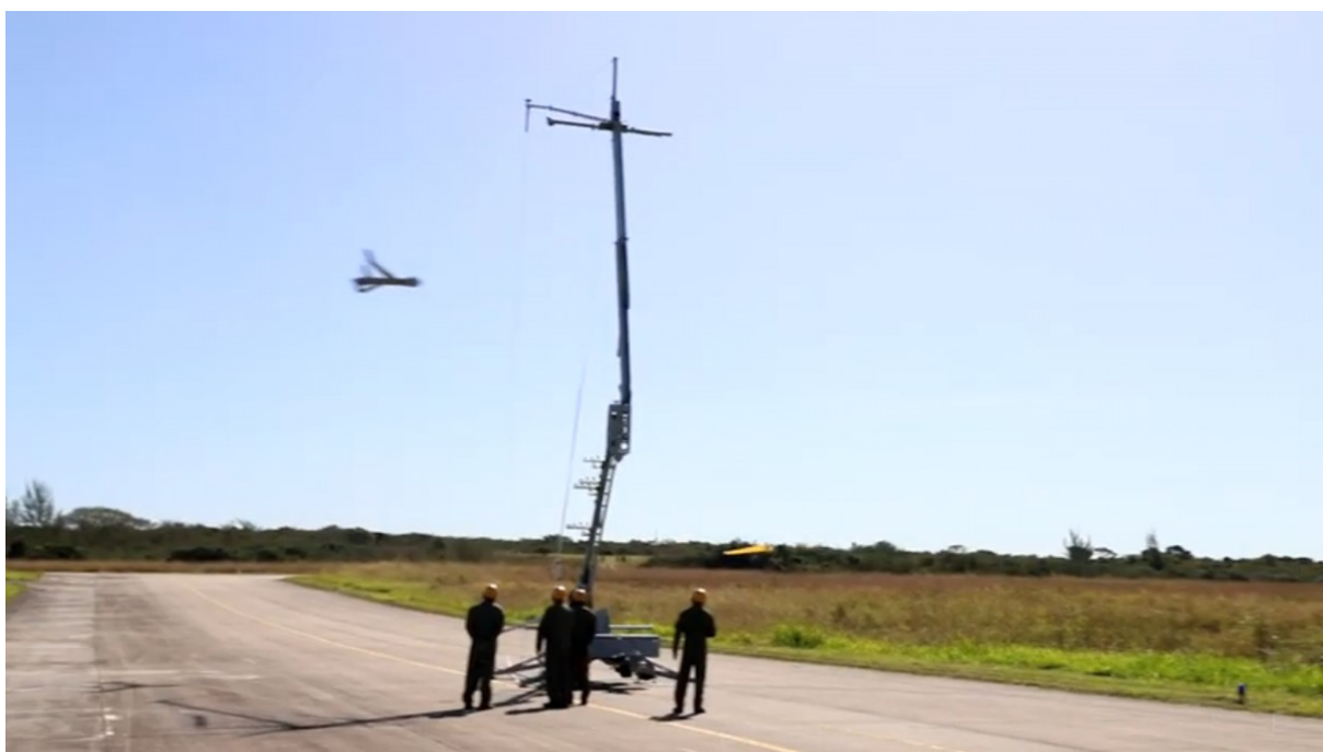
Figura 8 - Sistema de recolhimento do ScanEagle
