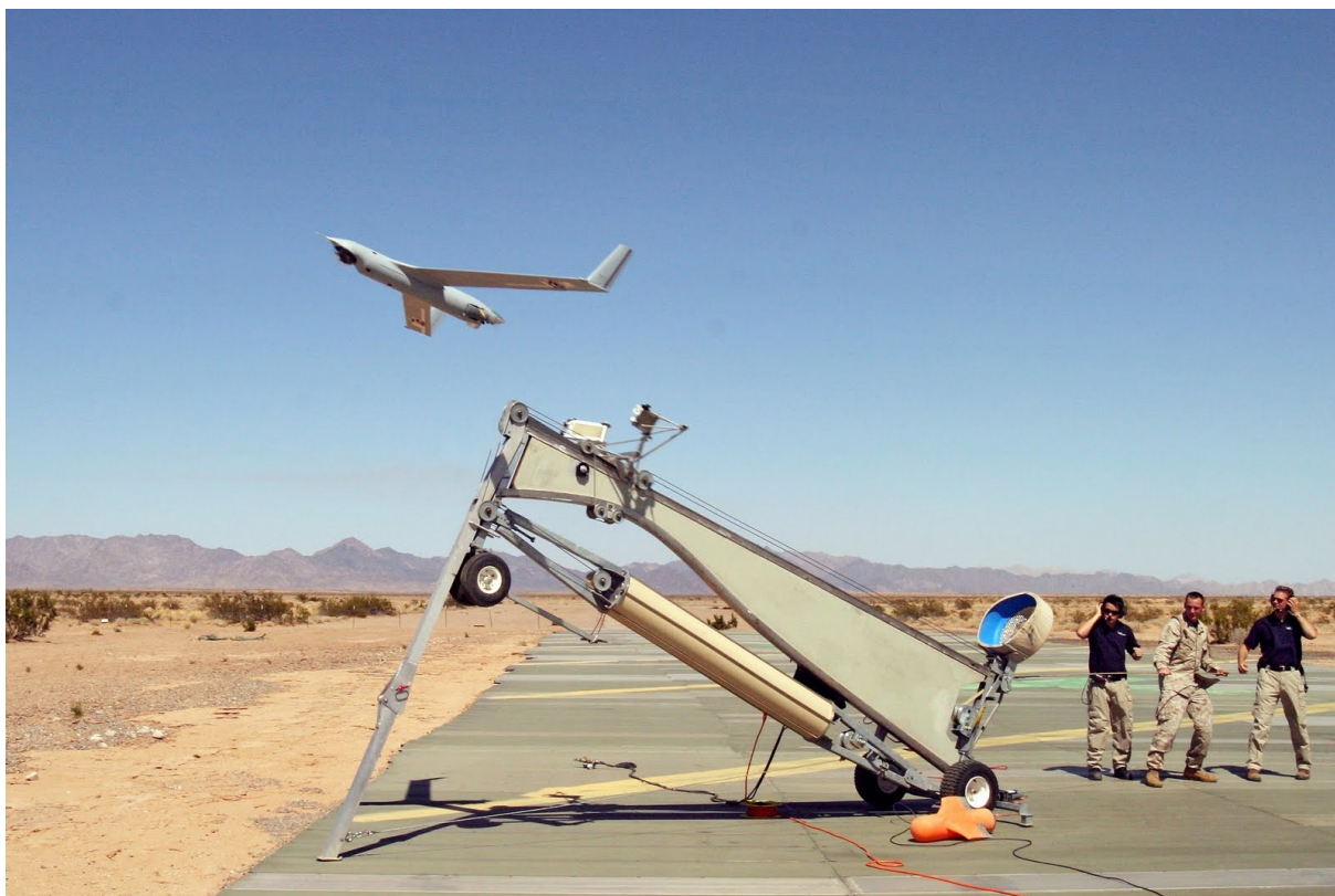
Figura 7 - Sistema de lançamento do ScanEagle
