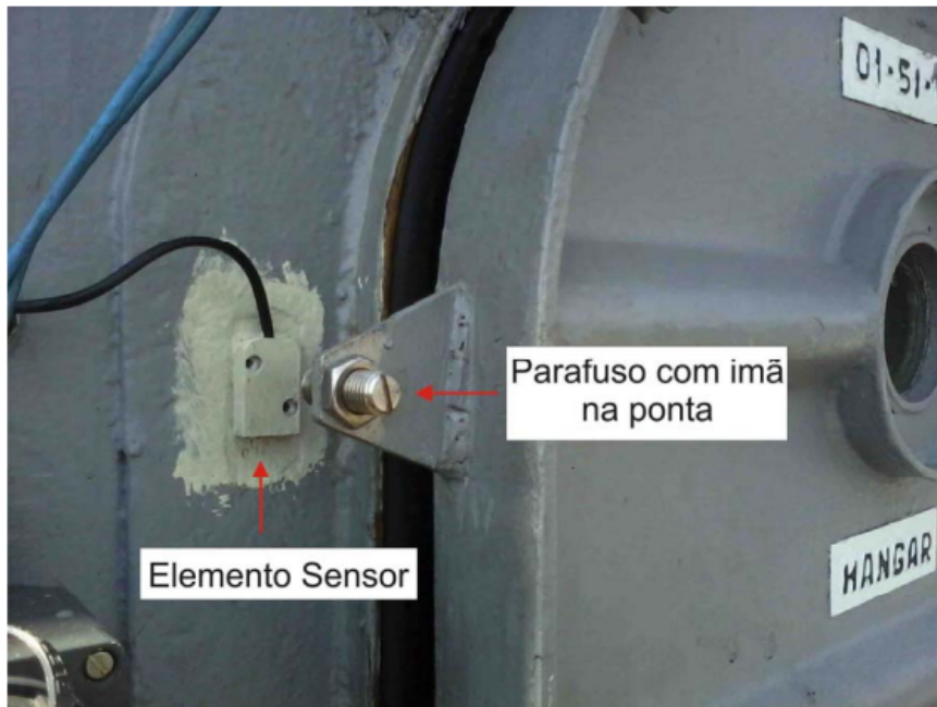
Figura 18: Conjunto Elemento sensor reed-switch e parafuso com ímã
