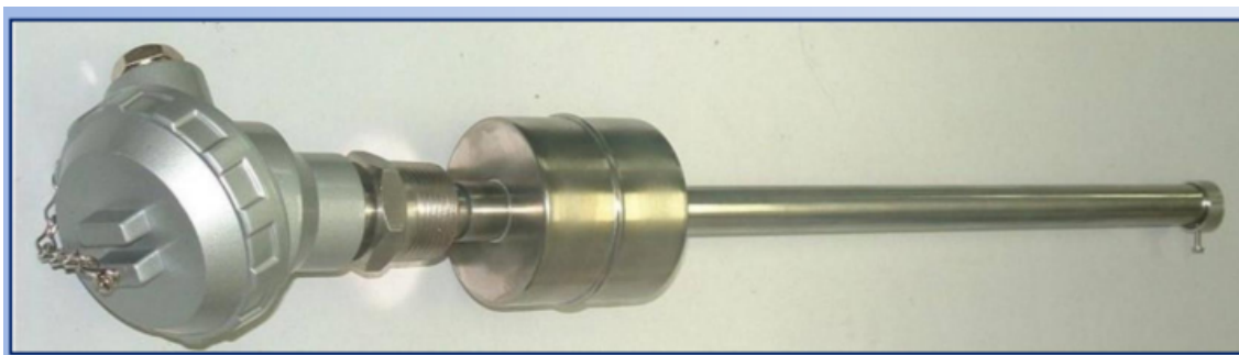
Figura 13: Sensor de Alagamento Fonte: Marinha do Brasil
